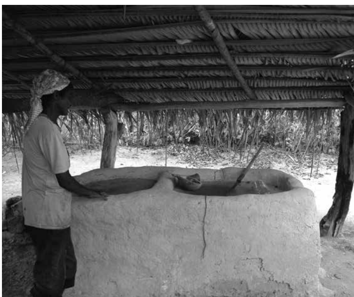
Figura 7: Forno de barro e lapa utilizados no processo de beneficiamento da farinha de mandioca. Comunidade do Quilombo, município de Minas Novas, Vale do Jequitinhonha/MG. Autor: DINIZ, R. F. 2010.
